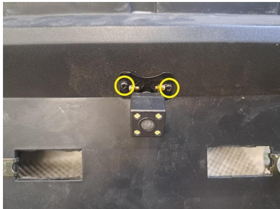
Irrota peruutuskameran kiinnitysruuvit (ristipäämeisseli ph2).
