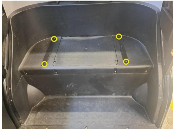
Irrota velcro tarranauhojen kiinnitysruuvit (ristipäämeisseli ph2).
