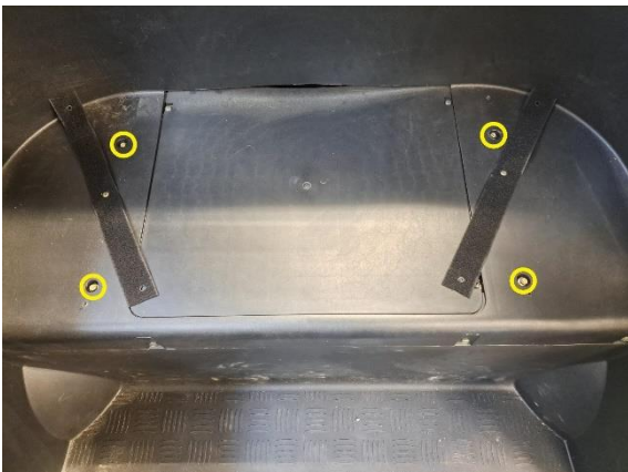
Käännä Velcro tarranauhat pois tieltä. Irrota tarranauhojen alta paljastuvat kiinnitysruuvit (hylsy 8 mm).
