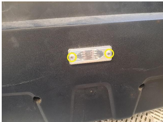
Irrota peruutusvalon kiinnitysruuvit (ristipäämeisseli ph2).
