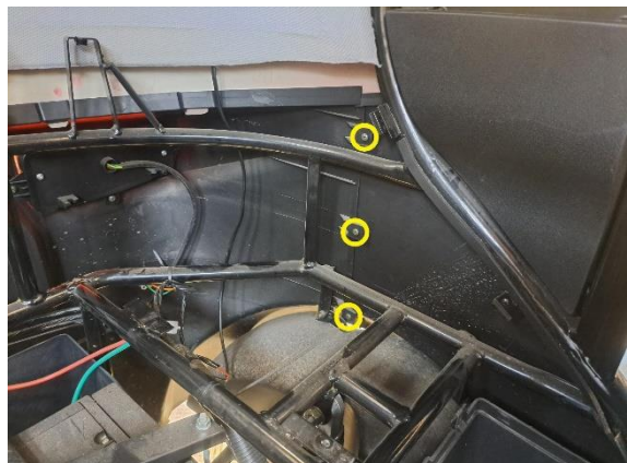
Irrota takapuskurin ja takalokasuojan väliset kiinnitysruuvit (ristipäämeisseli ph2).
