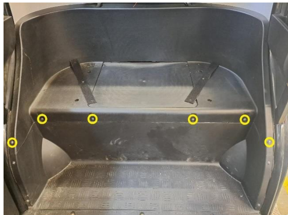
Irrota takaistuimen runko osan kiinnitysruuvit (ristipäämeisseli ph2).
